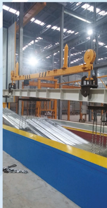
Opération de refroidissement et de passivation
