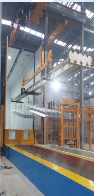
Opération de refroidissement et de passivation
